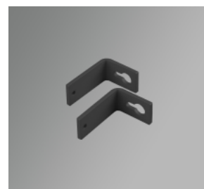
Väggfäste 2698 Svart (st). Väggfäste vid varje gavel, övriga cc-avstånd max 1500 mm. Beställs separat för både singel- och systemarmatur.
