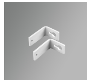
Väggfäste 2697 Vit (st). Väggfäste vid varje gavel, övriga cc-avstånd max 1500 mm. Beställs separat för både singel- och systemarmatur.
