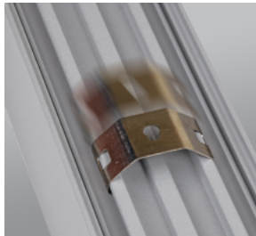
Takfästet är ställbart längs hela armaturens längd. Upphäng vid varje gavel. övriga cc-avstånd max 1500 mm.
