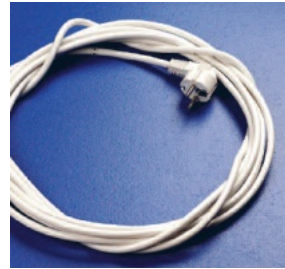
Vit PVC-fritt sladdställ 3x1,5 mm 2 , försedd med vinklad stickpropp. Längd 6 m eller 12 m från översta uttaget i staven.
