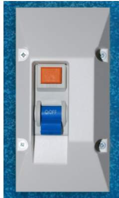
Jordfelsbrytare HAROK, 230 V, 25 A, brytström 30 mA med testfunktion.
