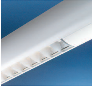
-MTP , tvärlamellbländskydd i aluminiumstrukturlack med paraboliska sidoreflektorer.
