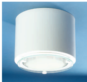
-BDG, blåstrat dekorationsglas Ø 225 , klarglasskiva med blåstrat mittparti. Försedd med diskret transparent distansring, vilken skyddar mot damm och insekter. Nerhäng under armaturen: 15 mm
