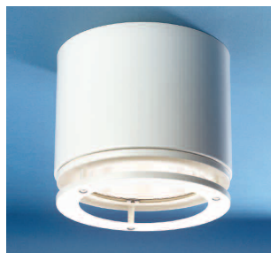
-DKR, vita dekoreringar Ø 225 av metall, dekorativt tillval som reflekterar ljus upp i taket runt armaturen. Nerhäng under armaturen: 35 mm -SAS diffuserande skiva som är placerad direkt under ljuskällan. Skivan döljer effektivt ljuskällan och minskar därigenom bländningseffekten.
