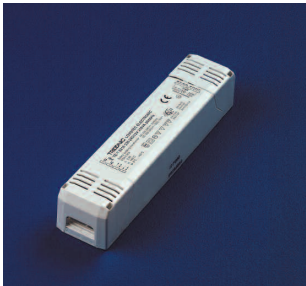
Elektronisk säkerhetstransformator med ljusreglering. Fabrikat Tridonic, TE one 4all (ljusreglering med switch DIM, DSI eller DALI) Klass II, IP20 Trafo 0402 , 105 VA, 230-240/12 V
