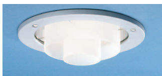
-TRR, aluminiumstruktur täckring Ø 225 av metall, -CYL, dubbla Satinécyllindrar Ø 225 , monterade i täckring. Ger armaturen en dekorativt lysande form som effektivt avskärmar ljuskällan. Nerhäng under armaturen: 62 mm
