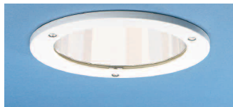
-TR, vit täckring Ø 225 av metall, -SAS, diffuserande skiva som är placerad direkt under ljuskällan. Skivan döljer effektivt ljuskällan och minskar därigenom bländningseffekten.
