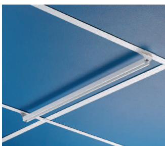
Armaturskena 9006, 600 mm (par) med armaturclips för T-profil (b=24 mm) kant A, C, E och D/G. Inklusive glidmutter och ögleskruvar.
