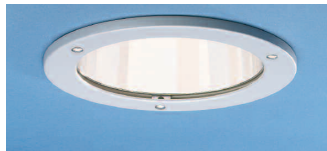
-TRR, aluminiumstruktur täckring Ø 225 av metall, -SAS, diffuserande skiva som är placerad direkt under ljuskällan. Skivan döljer effektivt ljuskällan och minskar därigenom bländningseffekten.
