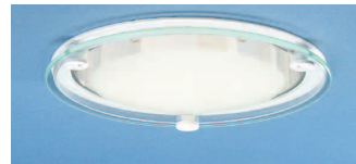
-BDG, blåstrat dekorationsglas Ø 225 , klarglasskiva med blåstrat mittparti. Försedd med diskret transparent distansring, vilken skyddar mot damm och insekter. Nerhäng under armaturen: 15 mm
