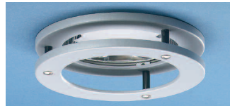
-DKRR, aluminiumstruktur dekoreringar Ø 185 av metall, dekorativt tillval som reflekterar ljus upp i taket runt armaturen, -SAS, diffuserande skiva som är placerad direkt under ljuskällan. Skivan döljer effektivt ljuskällan och minskar därigenom bländningseffekten. Nerhäng under armaturen: 40 mm
