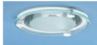
-BDG, blåstrat dekorationsglas Ø 185 , klarglasskiva med blåstrat mittparti. Försedd med diskret transparent distansring, vilken skyddar mot damm och insekter. Nerhäng under armaturen: 15 mm
