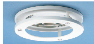
-DKR, vita dekorringar Ø 185 av metall, dekorativt tillval som reflekterar ljus upp i taket runt armaturen, -SAS diffuserande skiva som är placerad direkt under ljuskällan. Skivan döljer effektivt ljuskällan och minskar därigenom bländningseffekten. Nerhäng under armaturen: 40 mm
