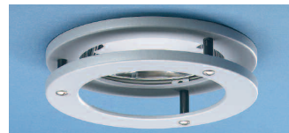
-DKRR, aluminiumstruktur dekorringar Ø 185 av metall, dekorativt tillval som reflekterar ljus upp i taket runt armaturen, -SAS, diffuserande skiva som är placerad direkt under ljuskällan. Skivan döljer effektivt ljuskällan och minskar därigenom bländningseffekten. Nerhäng under armaturen: 40 mm
