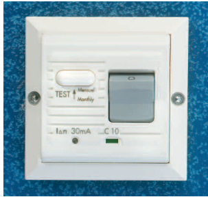
Jordfelsbrytare 230 V, 10 A, brytström 30 mA med test funktion.
