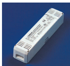
Elektronisk säkerhetstransformator med ljusreglering. Fabrikat Tridonic, TE one 4all (ljusreglering med switch DIM, DSI eller DALI) Klass II, IP20 Trafo 0402 , 105 VA, 240-245/12 V Trafo 0403 , 150 VA, 240-245/12 V
